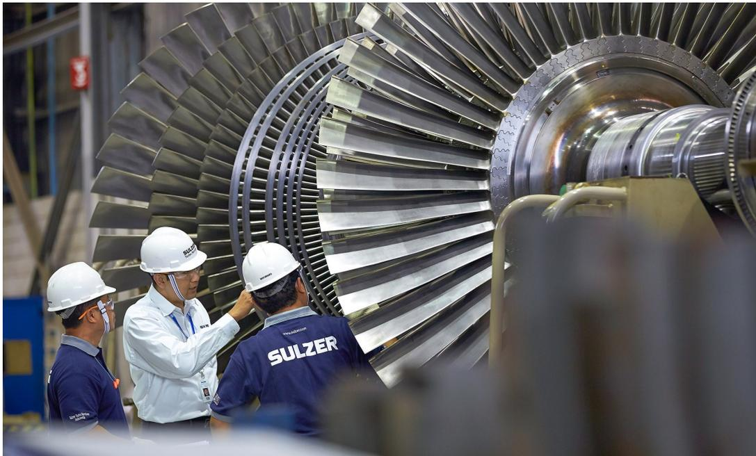
Die mobile Werkstatt von Sulzer Indonesien ermöglicht es den Teams, grosse Dampfturbinen direkt beim Kunden zu reparieren.
